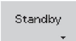
12. Помпата автоматично се изключва припл. 10 секунди след затваряне на спирателните устройства. Достигнат е нормалния режим на работа (Standby).
